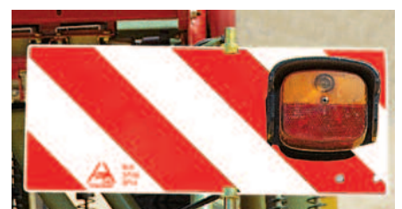
Markierungstafel mit Beleuchtungsvorrichtungen
