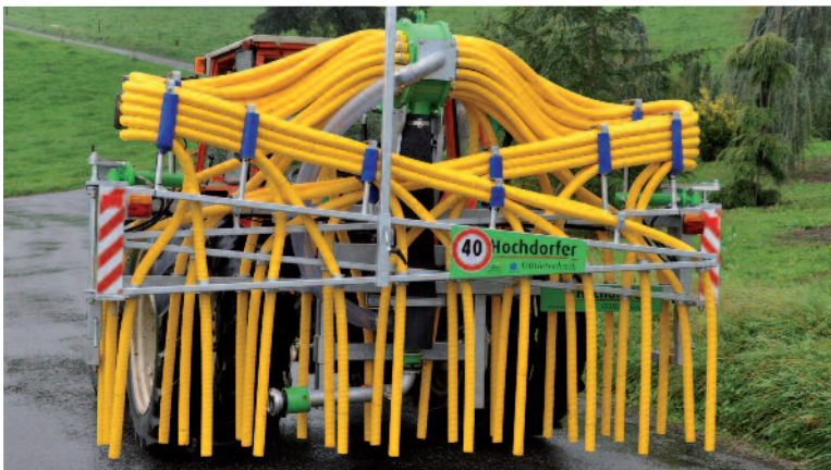
Die Konturen dieses Schleppschlauchverteilers sind trotz der gelben Schläuche nicht leicht erkennbar. Die Markierungstafeln dürfen nicht verdeckt sein und müssen nach hinten und vorne wirken. Werden die Beleuchtungsvorrichtungen und/oder Rückstrahler verdeckt, sind gleichwertige Ersatzvorrichtungen anzubringen.
