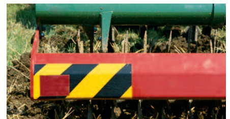
Schutz von Schneiden und Kanten
