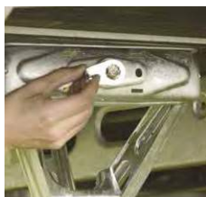
Mettre la sécurité anti-rotation.
