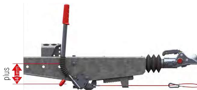
Levier de frein tiré (frein de parc en marche arrière au maximum)
